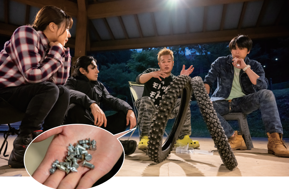
冬の宗谷岬アタックの必須アイテム、スパイクピン。神田さんは4輪のラリーで使用されるスパイクピンを輸入し自分でタイヤを作る。
